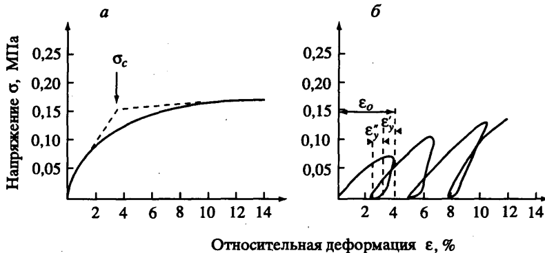
Рис. 36. Характер деформирования глинистых осадков из подзоны позднего диагенеза при одноосном сжатии:
