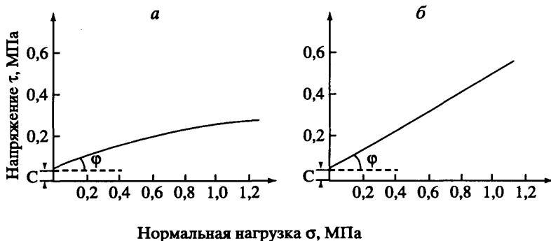
Рис. 40. Общий вид кривых сдвига \tau = f(\sigma) для осадков из подзоны позднего диагенеза: а – консолидированный недренированный сдвиг; б – консолидированный дренированный сдвиг
