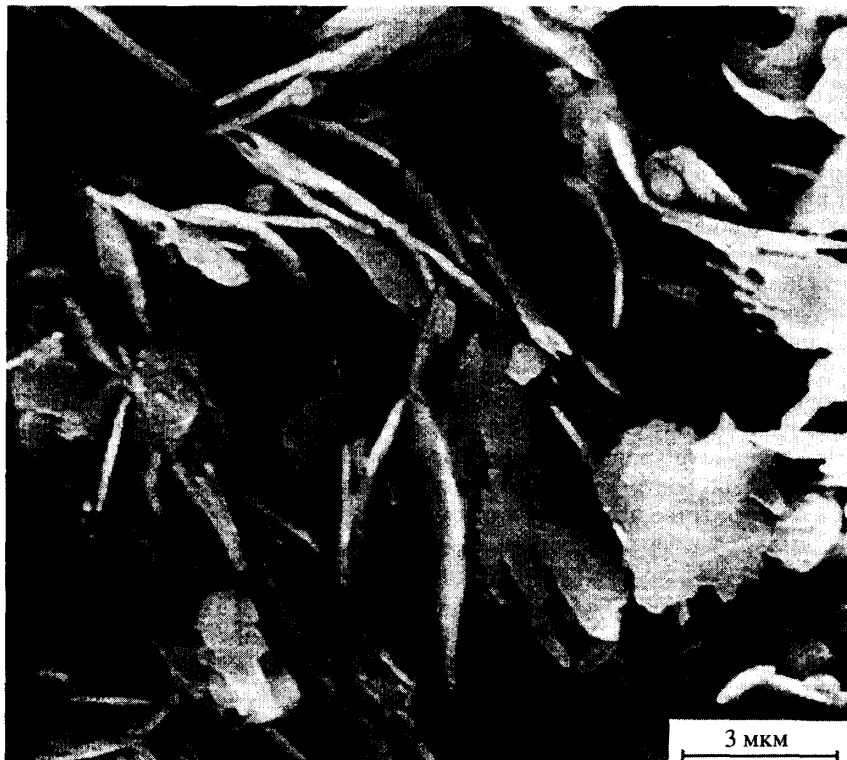
Рис. 65. Микроструктура морского осадка иллитового состава
