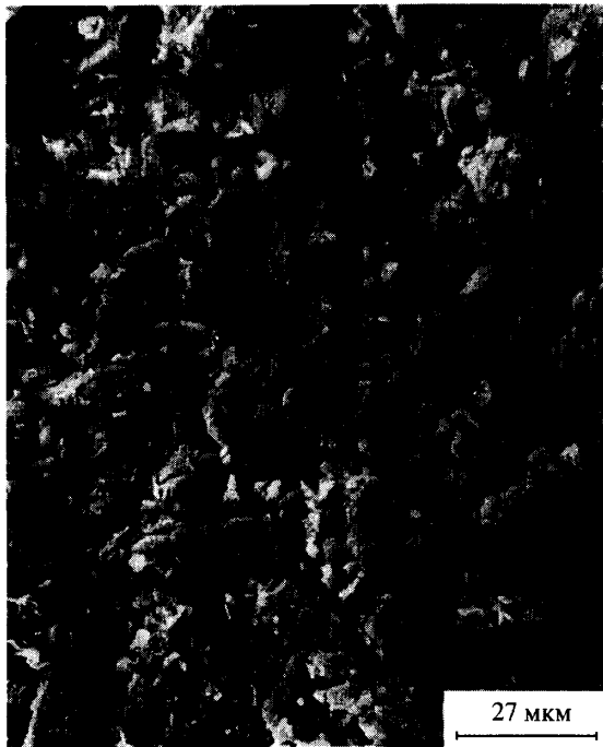
Рис. 94. Микроструктура образца легкой глины N_2^2 , глубина отбора 1200 м, р-н Бакинского архипелага; глинистая покрывка VI класса
