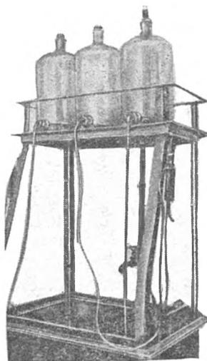
Рис. 159. Станок для хранения и заливки электролита СХЗ-2
