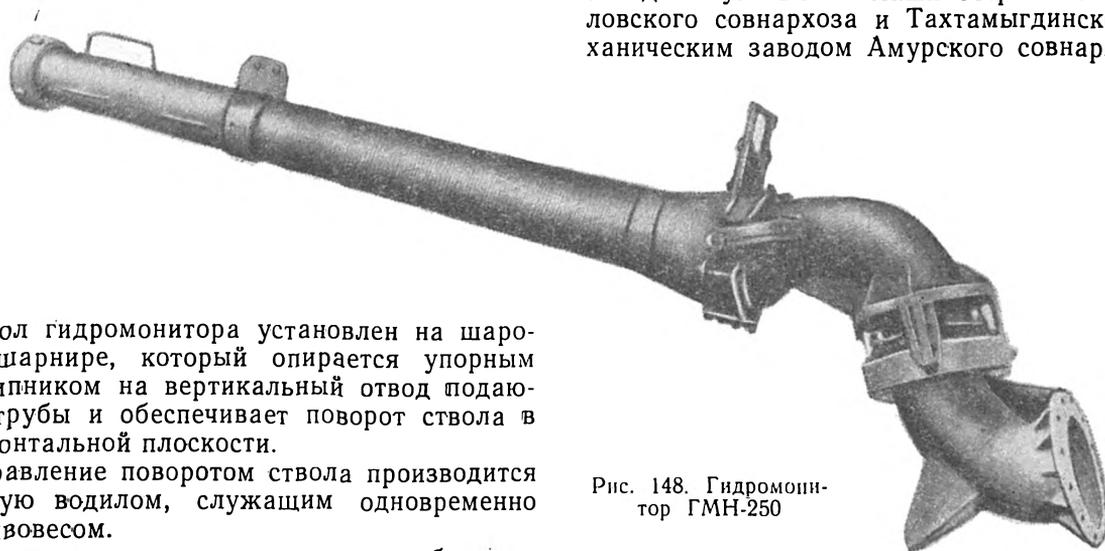
Ствол гидромонитора установлен на шаровом шарнире, который опирается упорным подшипником на вертикальный отвод подающей трубы и обеспечивает поворот ствола в горизонтальной плоскости.
