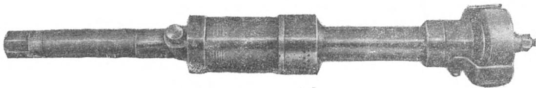
Рис. 144. Шлифовальная машинка ШР-06
