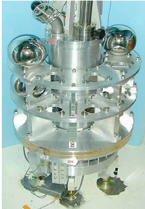
Рис. 4. Современные торсионные весы, используемые в Вашингтонском университете (перепечатано из /314/).
