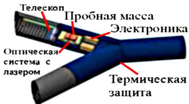
Рис. 20. Схема расположения телескопов, лазеров и пробной массы на космических кораблях проекта LISA /336/.
