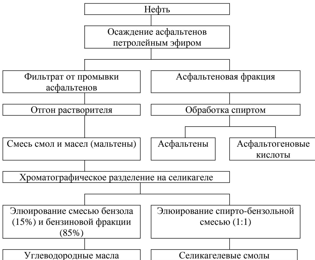
Рис. 4. Схема хроматографического разделения сырой нефти
