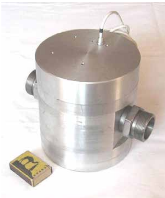
Рисунок 4.5 – Расходомер жидкости «НОРД-100» производства ООО «Вест-Метрология»
