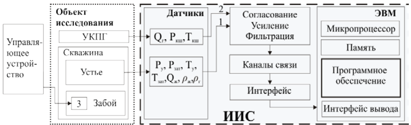
Рисунок 1.8 – Структура существующей ИИС добычи продукции газовой скважины с установкой электроцентробежного насоса [1 – давление ( P_y , P_{zat} ) и температура ( T_y , T_{zat} ) на устье и в затрубном пространстве скважины, расход ( Q_{ж} ) и плотность ( \rho_{ж} ) жидкости, плотность газа ( \rho_g ); 2 – давление ( P_{kш} ), температура ( T_{kш} ) в конце шлейфа, расход газа ( Q_g ), 3 – ПЭД]
