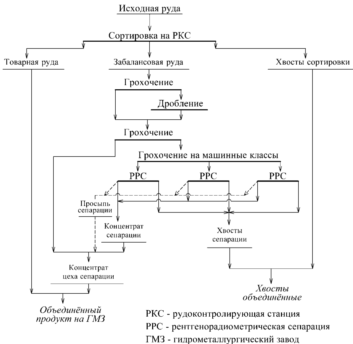
Рис. 10.7. Принципиальная технологическая схема рентгенометрического обогащения золотосодержащей руды месторождения «Кокпатас»
