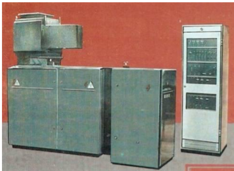
Рис. 8.11. Общий вид рентгенолюминесцентного сепаратора ЛС-20-05
