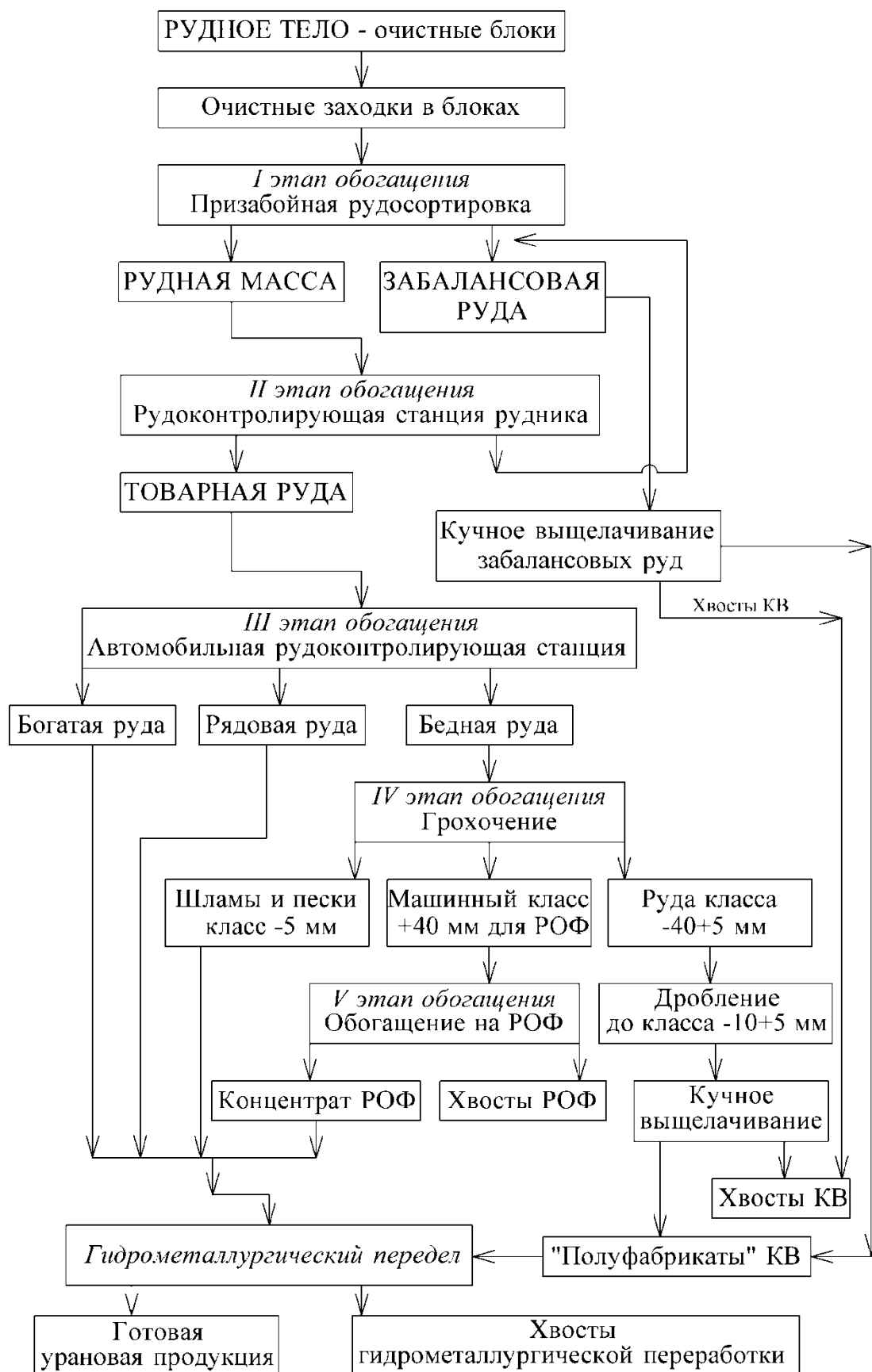
Рис. 10.12. Производственно-технологический комплекс по добыче, обогащению и гидрометаллургической переработке урановых руд
