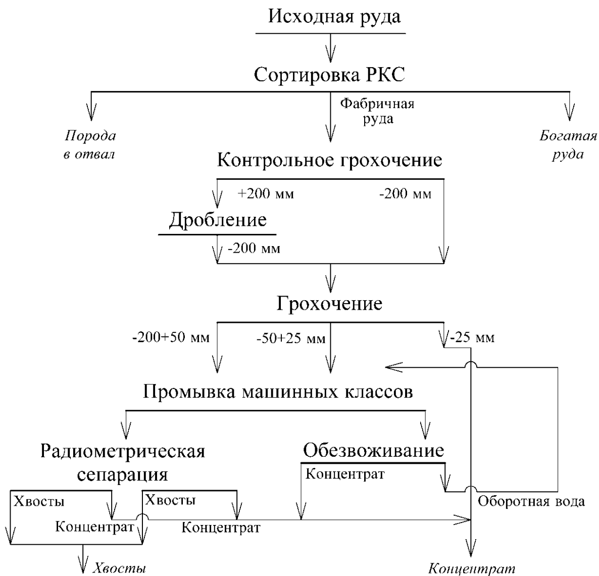
Рис. 10.10. Типовая технологическая схема радиометрического обогащения урановых руд
