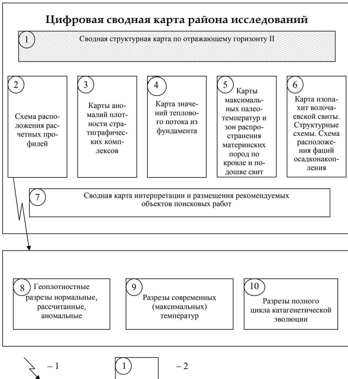
Рис. 5.4. Схема ГИС-проекта информационной базы результатов моделирования и прогнозирования нефтегазоносности на Хорском участке Средне-Амурской впадины. 1 – «горячая» связь, 2 – информационный блок и его номер
