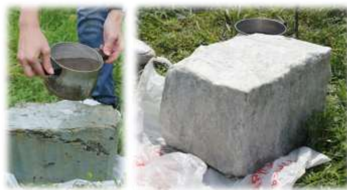
Рисунок 2.9 – Парафинирование монолитов синих глин (фотографии автора)
