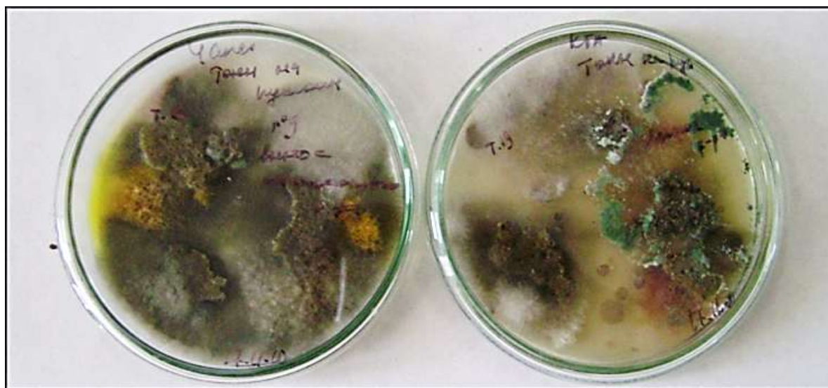
Рисунок 3.13 – Рост колоний плесневых микромицетов, изолированных на искусственные питательные среды из поврежденных материалов (обр. 4 -бетон и красочный слой). В пробе выявлено 5000 КОЕ в 1 грамме поврежденного материала
