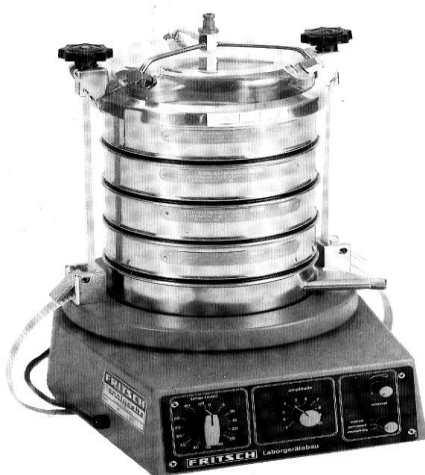
Рисунок 4.2 – Вибрационный анализатор для мокрого отсева сыпучих материалов фирмы Fritsch
