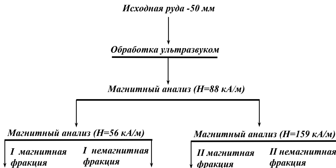
Рисунок 6.14 – Схема магнитного анализа сильномагнитных руд крупностью до 1 мм
