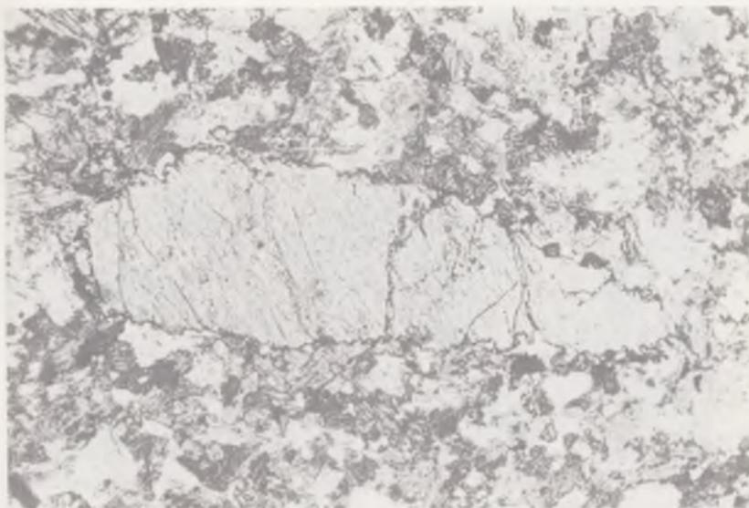
*Рис. 6.* Автолит неизмененного слюдяного кимберлита (E-8) – включение в массивном кимберлите трубки Удачная (глубина 400 м).
