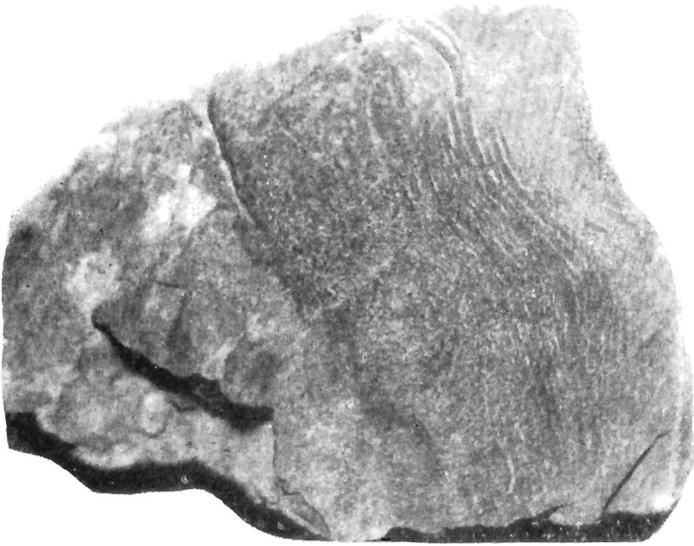
Фото 34. Контакт полосчатой вермикулит-франколит-апатитовой руды с фенитом.
