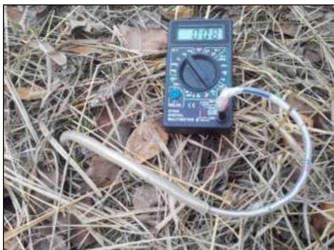
Рис. 5.13. Измерение температуры почвы на разных глубинах с помощью мультиметра DT838 с термпарой (слева) и тарировка мультиметра (фото Зубова А.Р.)
