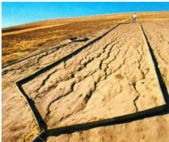
Рис. 3.5. Большая и малая стоковые площадки с водоотводящей трубой (фото с сайта USDA [225]).
