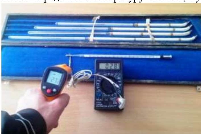
Рис. 5.16. Виды термометров: коленчатые Савинова, напочвенный, мультиметр с термопарой, инфракрасный
