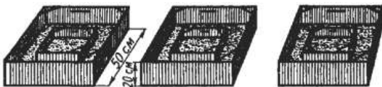
Рис. 5.2. Послойное изучение водопроницаемости почвы [203]
