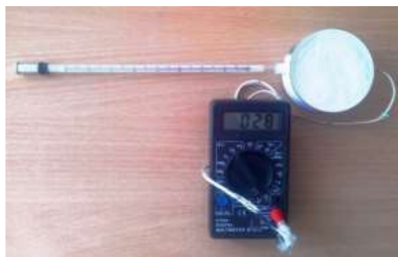
Рис. 5.13. Измерение температуры почвы на разных глубинах с помощью мультиметра DT838 с термпарой (слева) и тарировка мультиметра (фото Зубова А.Р.)
