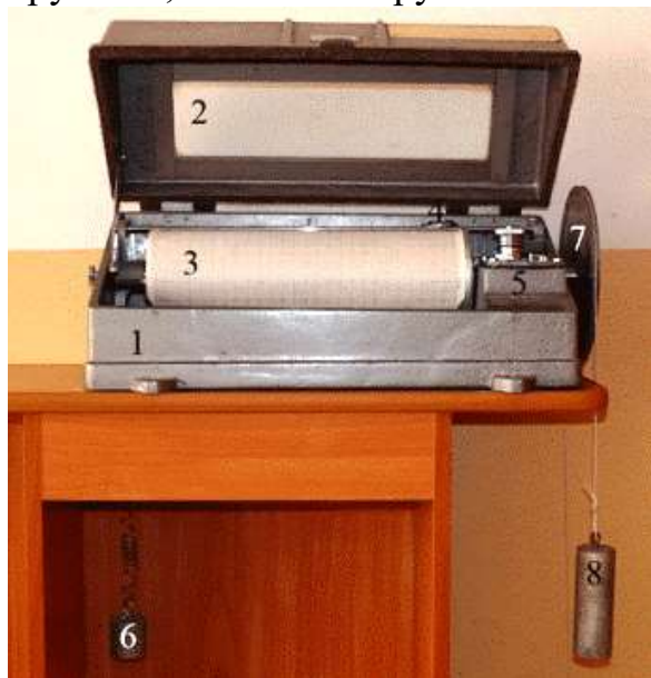
Рис. 3.13. Общий вид СУВ «Валдай» и его размещение: а) 1 - корпус прибора, 2 – крышка со стеклом, 3 – диаграммный бланк, 5 – часовой механизм, 6 – гиля часового механизма, 8 – гиля-противовес поплавка; б) 1 – крыша будки, 2 – труба, 3 – колодец, 4 – обсадная труба, 5 – столик, 6 – СУВ «Валдай»
