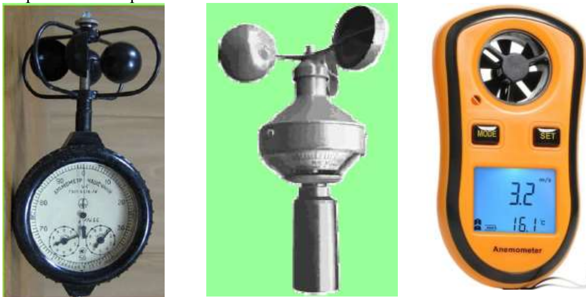
Рис. 5.19. Анемометры: чашечный МС-13, ручной индукционный АРИ-49, портативный электронный RZ GM 8908
