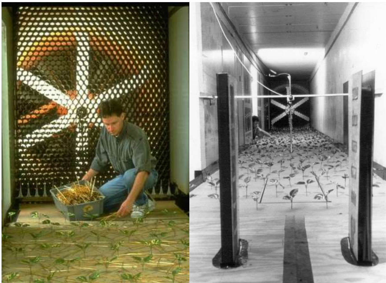
Рис. 3.58. Стационарная лабораторная аэродинамическая труба с нагнетающей турбиной, трубками Пито и двумя пылеуловителями [225]
