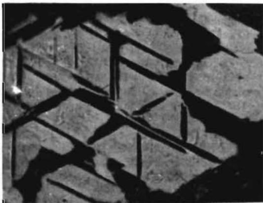
Рис. 45. Скелетное зерно титаномагнетита, образовавшееся вследствие частичного выщелачивания пластинок ильменита, Печенгский район, Аншлиф, при одном никеле, увел. 400.
