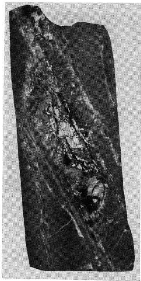
← Рис. 1.58. Карбонат-кварцевый прожилок с сульфидами (светлое) в сланцеватом амфиболите (черное). Полир. штуф. 9/10 нат. вел., обр. 20 568, гл. 6380 м
