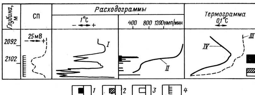
Рис. 3.4. Выделение работающих интервалов пласта и определение типа флюидов по данным механического и термоиндуктивного расходомеров и высокочувствительной термометрии: I – кривая, замеренная термоиндуктивным расходомером типа СТД; II – то же, механическим расходомером типа РГД; III, IV – термограммы, полученные в работающей и остановленной скважине соответственно.
