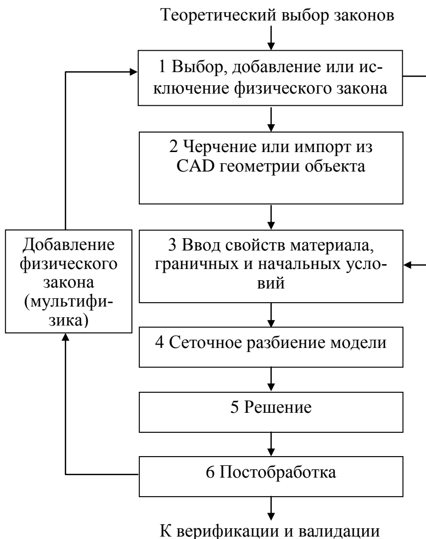
Рис. 6.9. Последовательность действий при мультифизическом компьютерном моделировании
