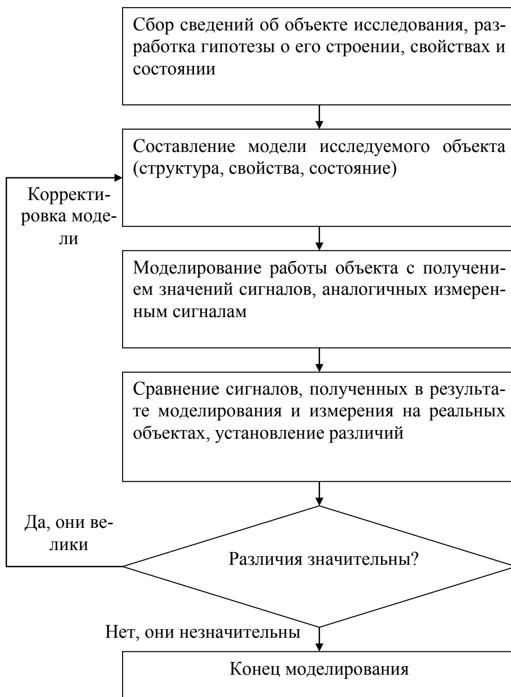
Рис. 6.5. Решение обратной задачи измерений с помощью компьютерного моделирования
