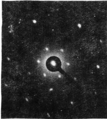
Рис. 4. Обр. Б.Патом, суспензия: а - отдельная планкообразная частица, ув. 14300; б - микродифракция от нее.
