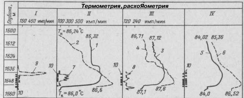
Рис. 73. Результаты исследований термометрией и расходомерией при первом (I), до второго (II), во время второго (III) и после второго (IV) акустического воздействия в скважине Западно-Муртымынского месторождения [16]. 1, 3, 5 — в работающей скважине; 2, 4, 6 — в остановленной скважине через 4 ч; 7, 8, 9 — результаты измерений РГТ; 10 — профили притока;  $T_n$ ,  $T_k$  — начальная и конечная температуры в скважине
