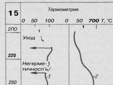
стволу скважины отмечается снижением градиента температуры выше места повреждения, при заколонном перетоке вниз по скважине место ухода жидкости в нижележащий пласт фиксируется повышением градиента температуры.
