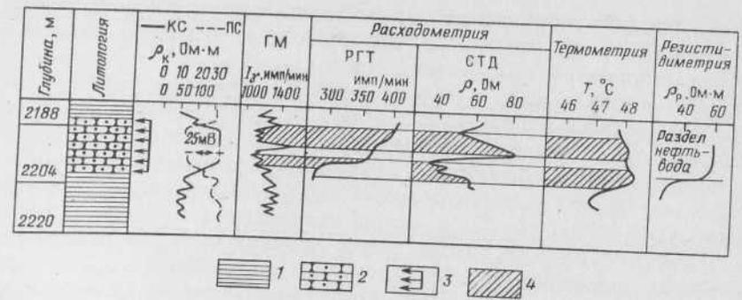
Рис. 58. Выделение работающих мощностей продуктивного пласта в скв. 267 Сосновского месторождения.
