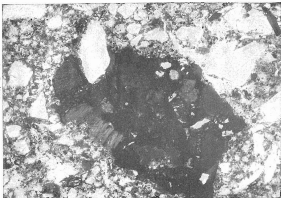
Фото 17. Обломок глауконитового песчаника, переотложенного из меловых пород, в санчуговском алевроите Ладыгина яра. Шлиф. \times 136 , николь \perp , обр. 10/30.
