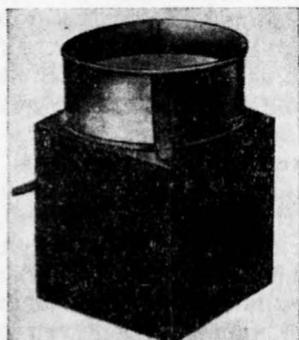
Рис. 14. Шлифовальный станок (портативный), на котором могут быть изготовлены аншлифы для люминесцентно-микроскопических исследований
