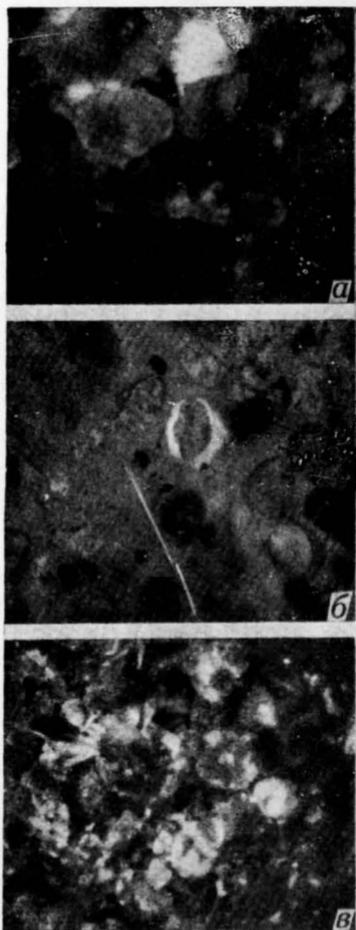
Рис. 19. Распределение битуминозных веществ в песчанике: *a* — точечное (поровое) в песчанике юрских отложений месторождения Узень, прозрачный шлиф; *б* — трещинное и межзерновое в песчанике верхнего мела месторождения Узень, прозрачный шлиф; *в* — неравномерно-насыщенное в песчанике девонских отложений Татари, аншлиф. Осветленные участки — битуминозные вещества
