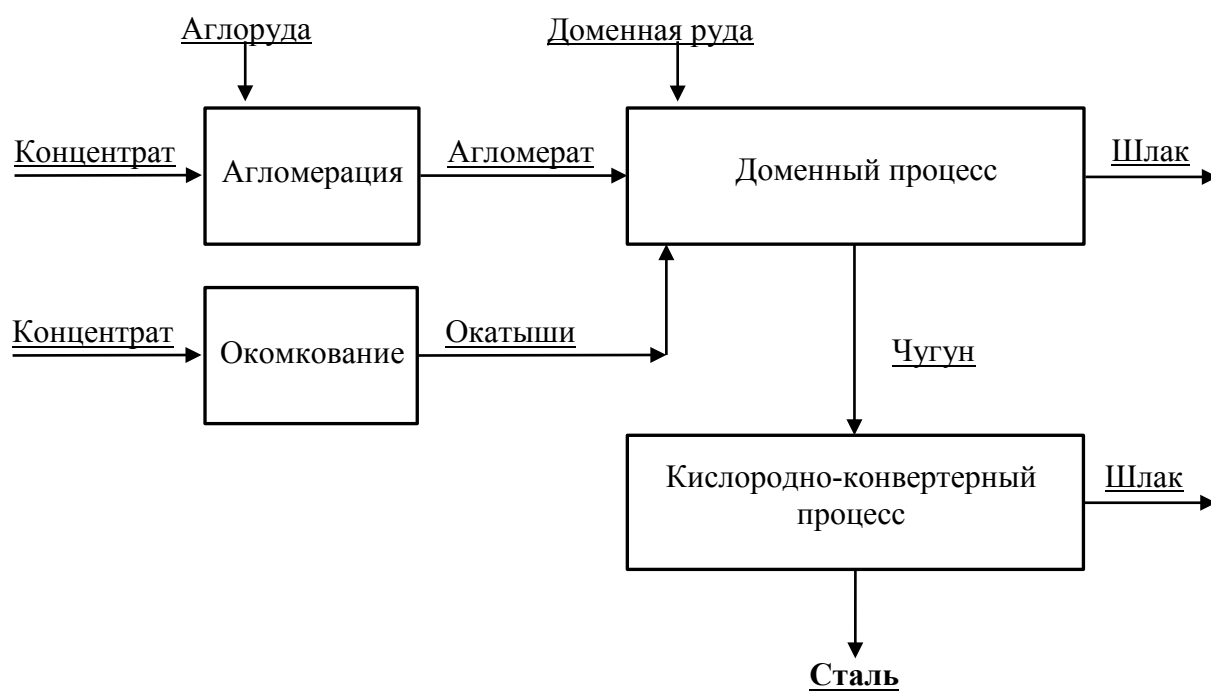
Рис. 5.1. Получение стали по схеме «домна-конвертер»
