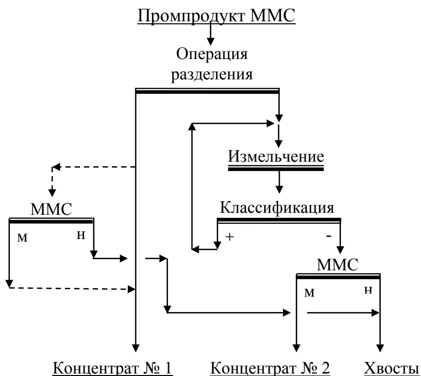
Рис. 5.9. Принципиальная схема стадийного выделения концентрата
