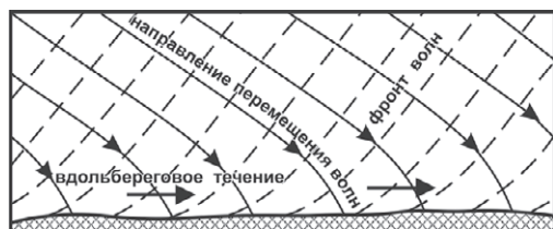
Рис. 3.10. Схема формирования вдольбереговых течений.
