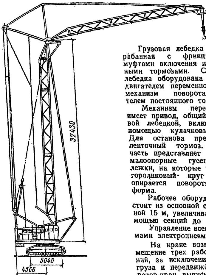
Рис. 12. Гусеничный кран СКГ-63Д с башенно-стреловым оборудованием
