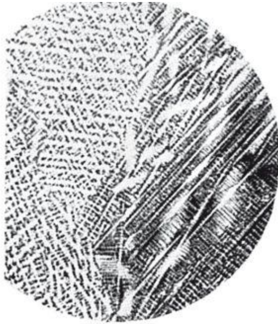
Рис. 7.6. Микроструктура никель-кремнистой бронзы БрКН1-3, 75. Дендритные зерна \alpha -твердого раствора сложного состава.
