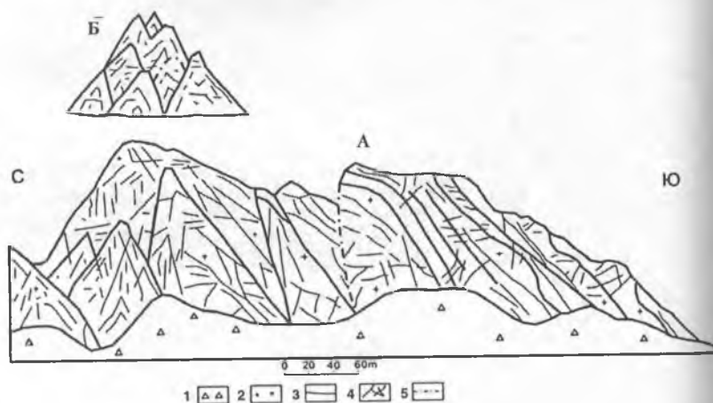
Рис. 2.8. Схема разрывных нарушений в скальных обнажениях Эльджуртинских гранитов на правом берегу р. Баксан у юго-западной окраины г. Тырныауз (составлена по данным полевой документации и дешифрирования панорамных фотоснимков):
