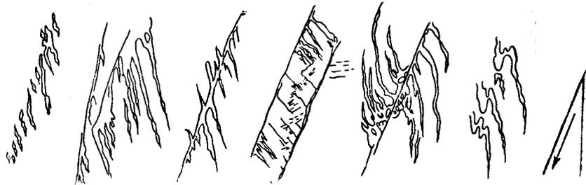
Рис. 94. Система перистых трещин, частью заполненных жильным материалом. Во всех случаях левая глыба приподнята, правая — опущена
