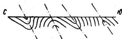
Рис. 11. Схематический разрез несимметричных опрокинутых складок
