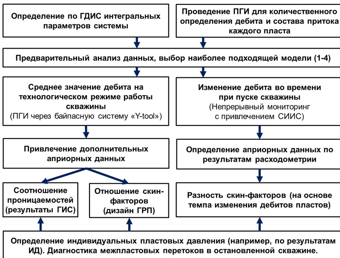
Рисунок 2.29 - Блок-схема алгоритма совместной интерпретации результатов промысловых и гидродинамических исследований для многопластовых нефтяных объектов
