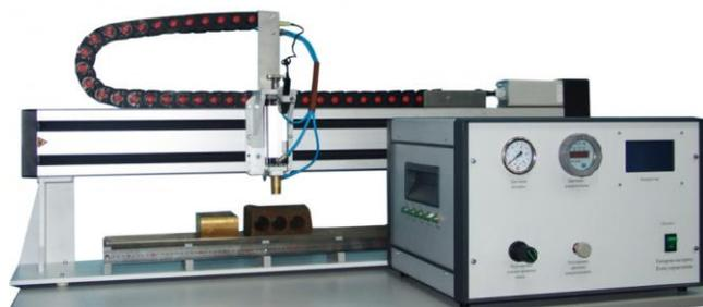
Рис. 6.9. Зондовый пермеаметр «Геопрон-Экспресс»
