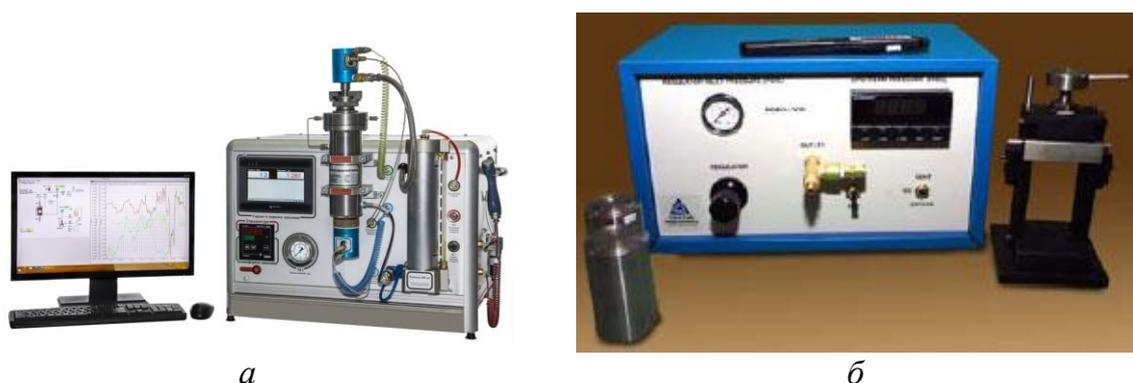
Рис. 6.2. Автоматизированный прибор для измерения пористости и проницаемости «ПИК-ПП (а) и газовый порозиметр с ручным управлением PORG-200 производства CORE LAB (б)
