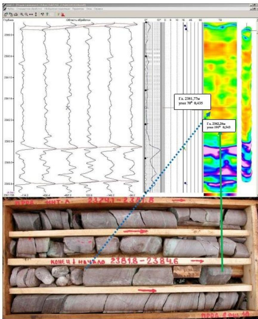
Рис. 3.12. Пример определения азимута простирания субвертикальной трещины (интервал 2 380–2 383,5 м; скв. К-220)
