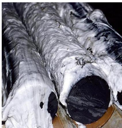
Рис. 1.5. Изолированный керн с использованием системы Gel Coring<sup>SM</sup> System [19]
