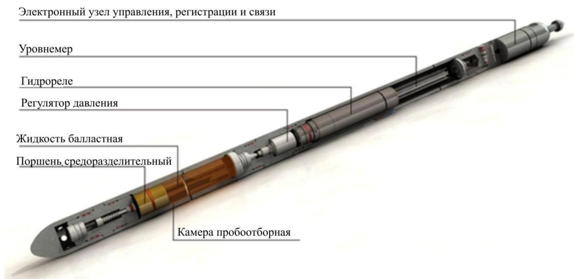
Рис. 11.7. Общий вид пробоотборника типа СИМСП 20 ВМ
