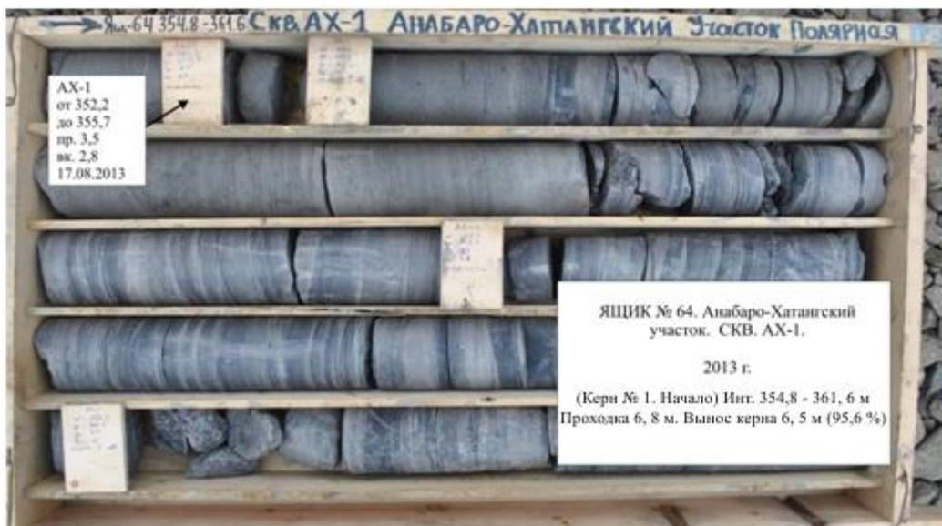
Рис. 1.7. Пример укладки керна из скв. Ах-1 Полярной ГРЭ
