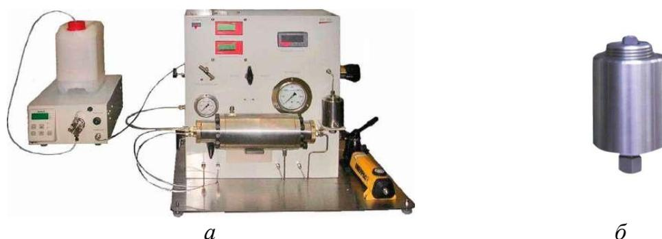
Рис. 6.5. Общий вид настольного жидкостного пермеаметра с ручным управлением ВРС-350 (*а*) и регулятора противодействия ВРР (*б*)
