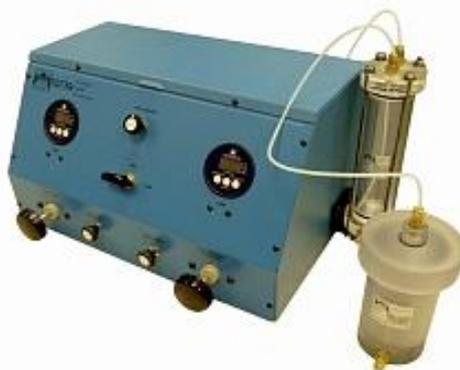
Рис. 6.18. Общий вид капилляриметра TGC-764 фирмы Core Test
