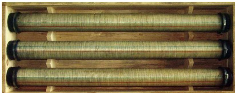
Рис. 1.4. Керн, вынесенный изолирующим керноприемником
