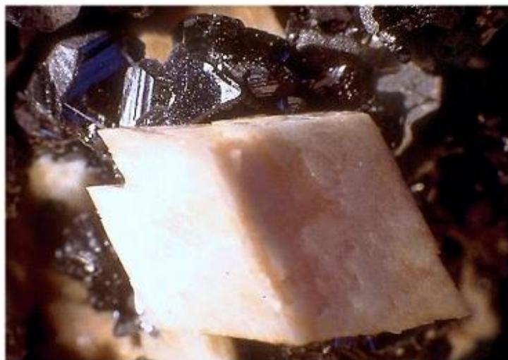
Рис. 3.2. Кристалл доломита тригональной сингонии, основного минерала, слагающего карбонатные коллекторы Юрубчено-Тохомской зоны
