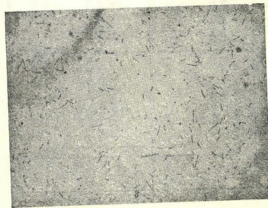
Рис. 24. Следы пробега \alpha -частиц (треков) на микрорадиографиях при экспозиции 13 часов (а), 1 сутки (б), 8 суток (в) и 20 суток (г). Ув. 200
