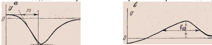
Рис. 4.25. Характерные точки, используемые для интерпретации данных метода ЕП
