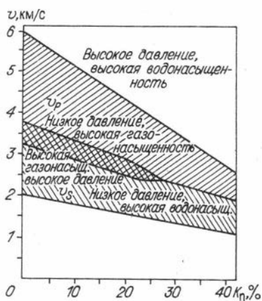
Рис. 2.9. Влияние насыщенности флюидами и всестороннего давления на скорость продольных и поперечных волн в цементированных осадочных породах. Давление изменяется в пределах 0—70 МПа.
