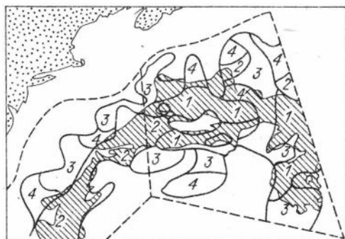
Рис. 11.8. Фрагмент карты распределения отражательной способности дна для восточного побережья Северной Америки [8]. 1, 2 — области с максимальным, 4 — с минимальным коэффициентами отражения; 3 — промежуточные значения.
