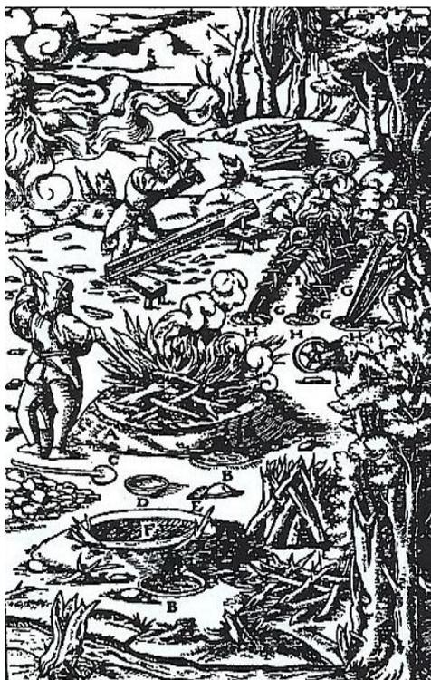
*Рис. 33. Один из наиболее распространённых в раннем средневековье способов выплавки меди и железа с использованием дров в специальных ямах. На рисунке изображены: А – яма с уложенными под ней дровами; В – передний горн; С – черпак (кови); D – железная изложница (форма); E – куски выплавленного металла; F - порожняя яма, выложенная каменными плитами; G – лотки; H – сборные ямы; I – хворост для разжигания дров; K – ветер. Гравюра из книги Агриколы «О горном деле».*
