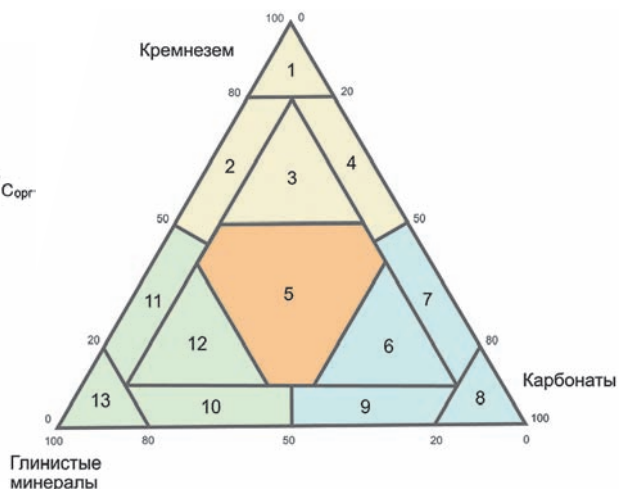
▲ Рис. 3.20. Трехкомпонентная номограмма для определения названия пород БС по их минеральному составу
