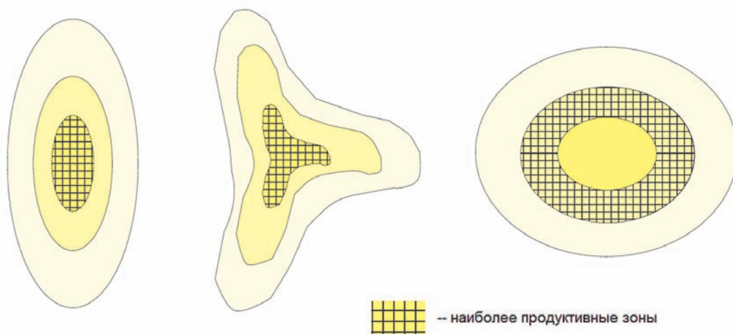
▲ Рис. 5.69. Схематическое сопоставление структурного строения трех месторождений и продуктивных зон в БС
