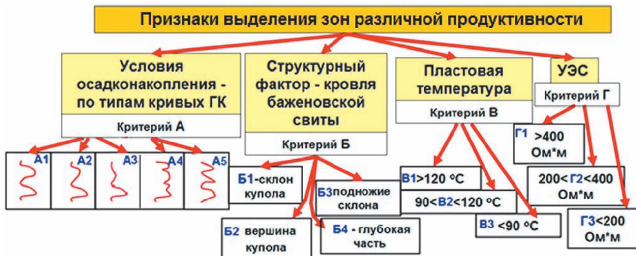
▲ Рис. 5.2. Косвенные признаки для выделения зон разной продуктивности отложений БС
