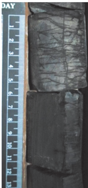
▲ Рис. 2.30. Фото керна глинистого силицита с техногенной сетью трещиноватости, развитой на поверхности колонки керна
