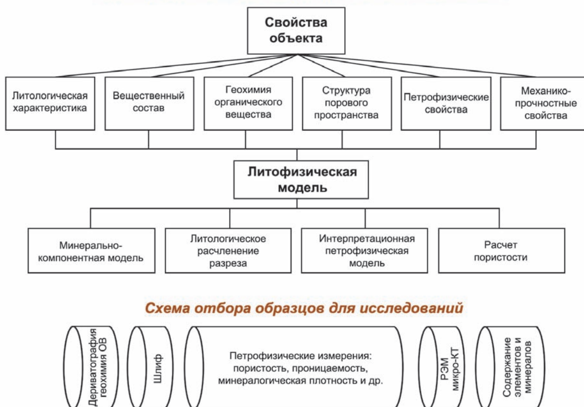
▲ Рис. 4.3. Блок-схема предлагаемых исследований керна, адаптированная к высокоуглеродистым отложениям
