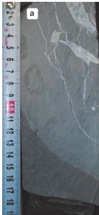
▲ Рис. 2.31. Известняки разбиты трещинами. Трещины залечены кальцитом
