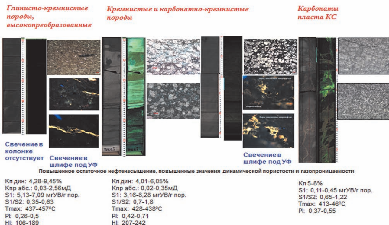
▲ Рис. 2.29. Породы, содержащие подвижную извлекаемую нефть, характеристика их свечения в ультрафиолетовом освещении, величина ФЕС и геохимические параметры
