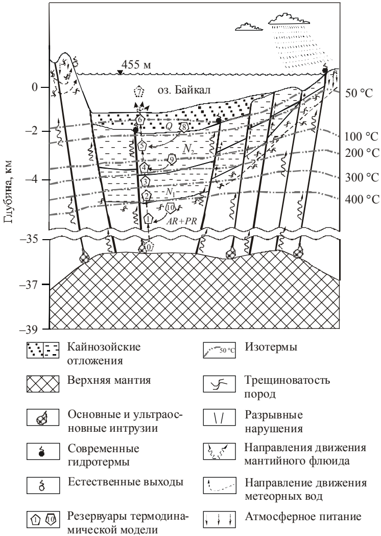
Рис. 3.3. Обобщенная структурно-гидрогеологическая схема физико-химической модели формирования гидросферы Байкальского рифта: Q – полигенетические фации молассовой формации четвертичного возраста; N_2 – грубообломочная молассовая формация верхнего неогена; N_1 – тонкообломочная молассовидная формация нижнего неогена; AR + PR – магматические и метаморфические образования архейско-протерозойского возраста
