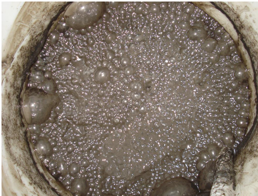
Рис. 4.4. Процесс флотации измельченной отвальной породы
