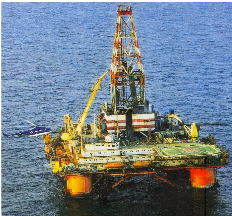
Рис. 3. Полупогружная буровая платформа
