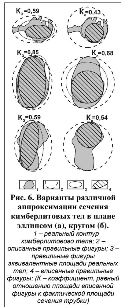
**Рис. 6. Варианты различной аппроксимации сечения кимберлитовых тел в плане эллипсом (а), кругом (б).**
