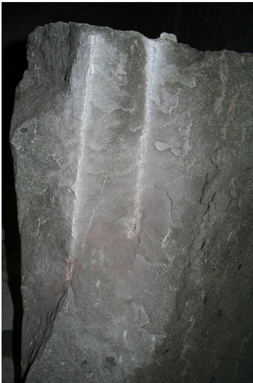
Рис.3.2. Параллельные перфорационные каналы при отстреле перфоратора типа «СПАРКА» в мишени. Расстояние между парами зарядов равно шагу (плотность перфорации 14отв./м) – 70мм. Глубина пробития порядка 350мм.
