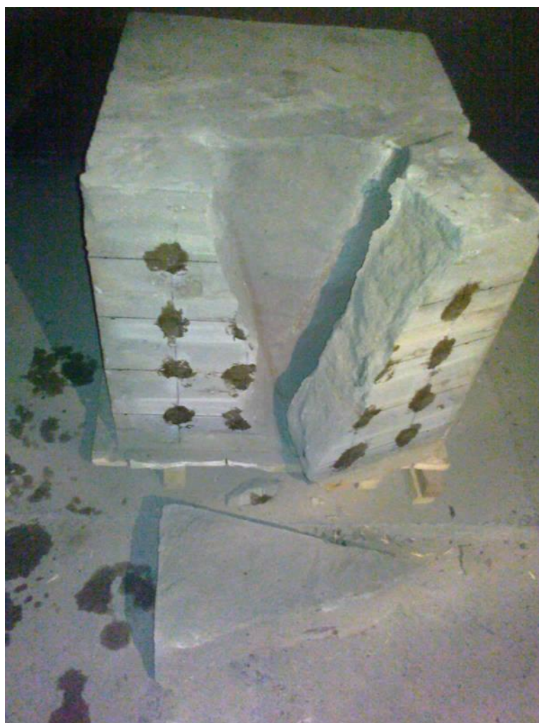
Рис.3.3. Траектории сходящихся перфорационных каналов при применении перфоратора типа «СПАРКА»
