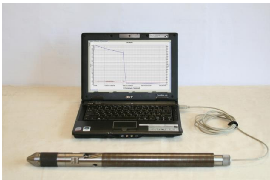
Рис. 8.2. Модуль измерения давления и температуры МИГ36
