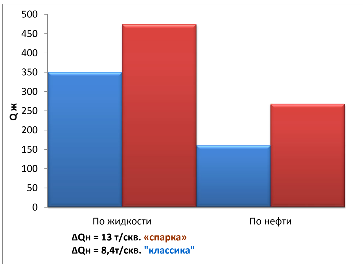
Рис. 3.14. Результаты реперфорации скважин перфораторами типа «СПАРКА»
