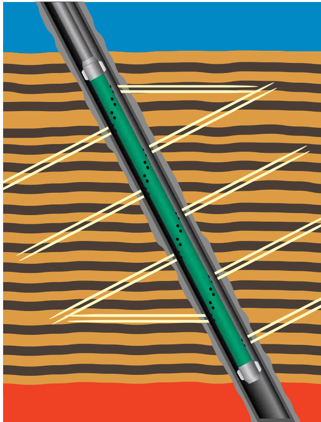
Рис. 3.16. Изменяемый наклон перфорационных каналов
