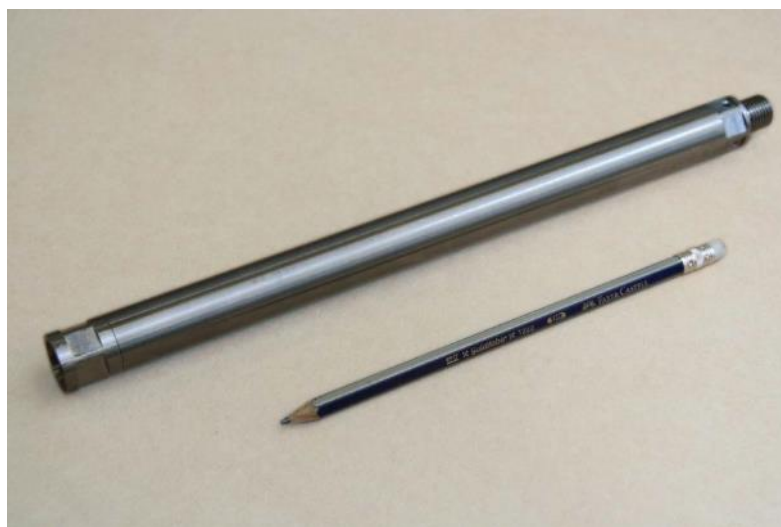
Рис. 8.17. Регистратор автономный малогабаритный РАМ1
