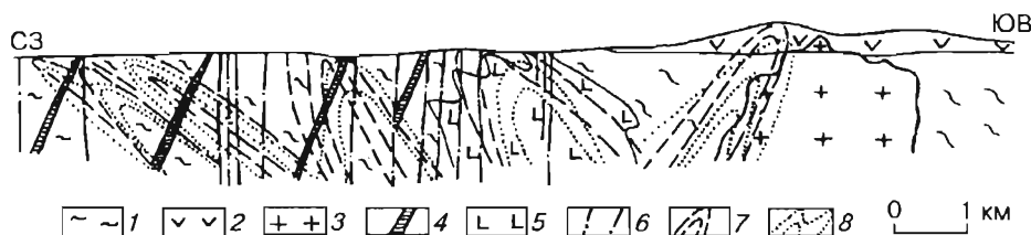
Рис. 63. Эндогенные геохимические аномалии Au и As в черносланцевых толщах карбона Боко-Васильевского рудного поля (месторождения Боко, Васильевское, Токум), Западная Калба (продольный разрез через рудную зону, упрощенный вариант):
