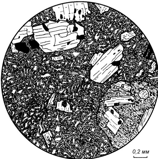
**Рис. 40.** Туф андезита пепловый, кристалловитрокластический с цементом уплотнения и поровым микрозернистым гидрохимическим хлоритовым цементом. Без анализатора.
