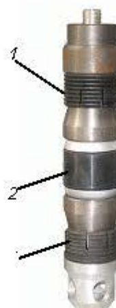
Рис. 5.10. Пакер ПВЦ: 1 – шпильки; 2 – резиновая манжета
