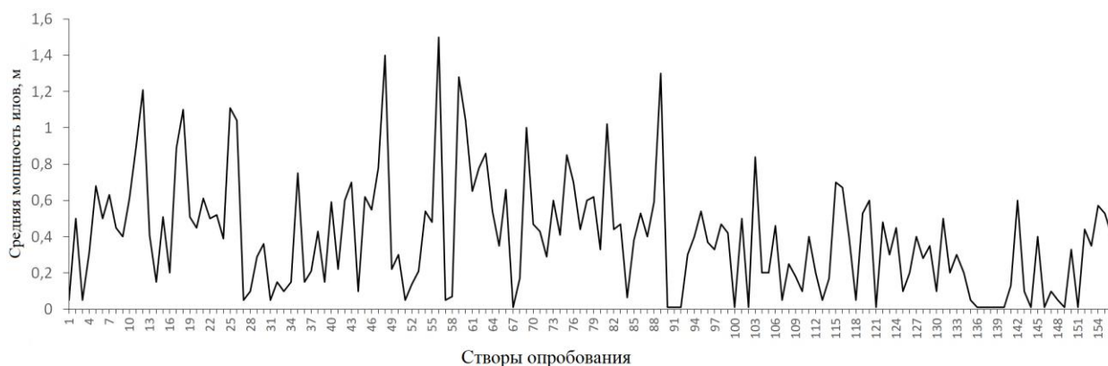
Рис. 52. Средняя мощность техногенных илов в русле р. Нуры (створ 1 – окраина г. Темиртау; шаг опробования: створы № 2–100 – через 250 м; далее – через 1 км; протяженность изученного участка русла – около
