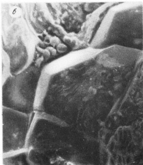
Фиг. 40. Гематитовая вкрапленность (белое) в шлаке по песчанику тяготеет к границам пор. Обр. 1, аншлиф, ув. 10.
