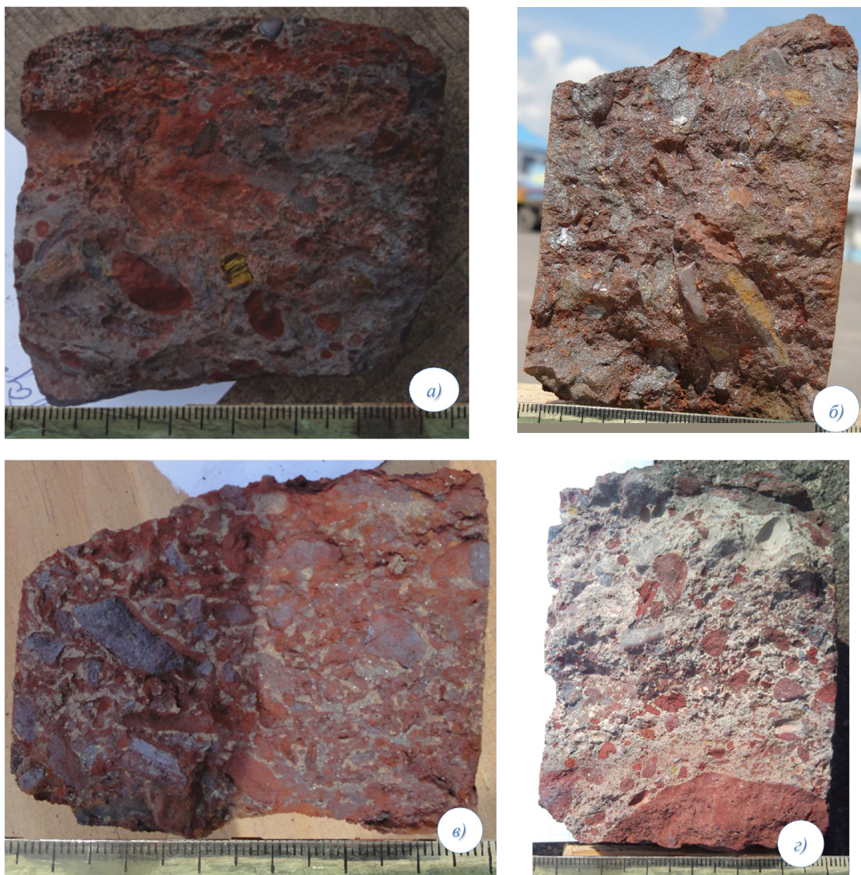
Рис. 6.11. Переотложенные богатые железные руды Большетроицкого месторождения: а) скв. 2р, гл. 491,6 м; б) скв. 10р, гл. 493,0 м; в) скв. 12р, гл. 480,5 м; г) скв. 19р, гл. 459,3 м.
