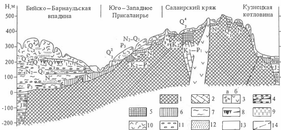
Рис. 15. Строение рельефа и рыхлого чехла Салаирского кряжа (по А. М. Малолетко [1972] с дополнениями):
