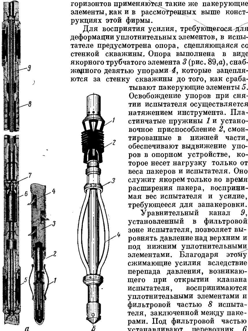
Рис. 89. Компоновка нижней (опорной) части испытателя пластов без опоры на забой фирмы Джонстон.
