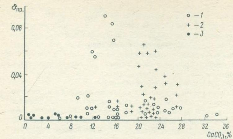
Рис. 1. Зависимость относительной просадочности от содержания  $\text{CaCO}_3$
