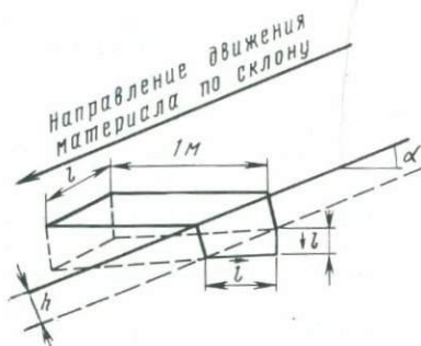
Рис. 3. Схема смещения материала по склону для системы единиц скорости относительно удельного отрезка длиной 1 м, нормального к направлению движения.
