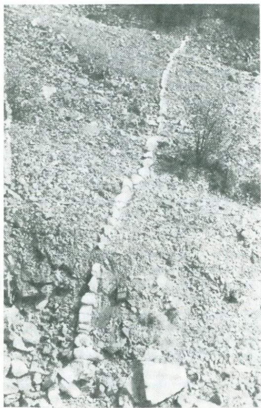
Рис. 33. Прокрашенный створ в селевом русле. Прибайкалье, селевой бассейн на юго-восточном склоне Баргузинского хребта
