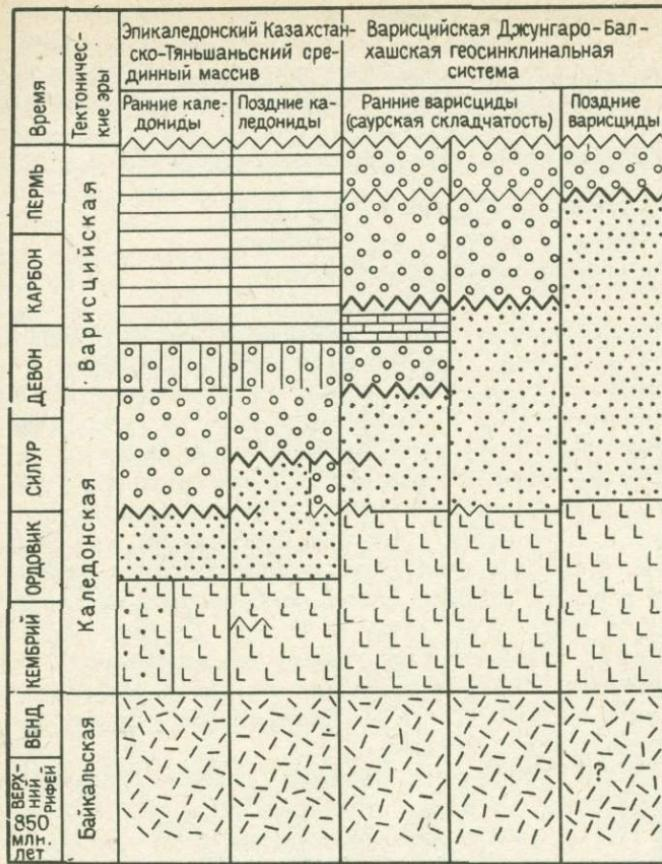
Рис. 2. Схема тектонической эволюции палеозойд Казахстана (миогеосинклинальные варисцийские системы Большого Карагата, Сарсы-Тенизская и др. в схему не включены):
