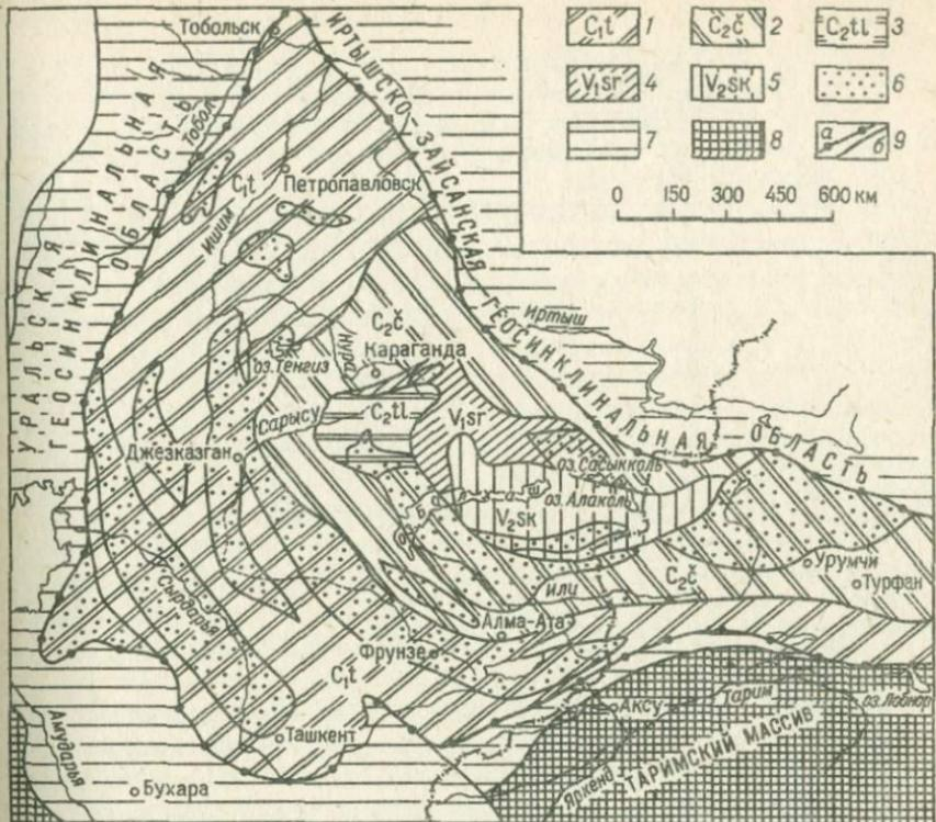
Рис. 41. Схема миграции главных складчатостей, отражающих прогрессирующую консолидацию Казахстанско-Тяньшаньского геосинклинального овала (мийогеосинклинальные системы и другие области возвратной, понятной, тектонической активизации – регенерации геосинклинального режима; орогенные впадины и краевые вулканические пояса – сняты)
