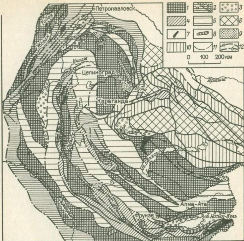
Рис. 3. Тектоническая схема докембрийского метаморфического фундамента палео-зоид Казахстана
