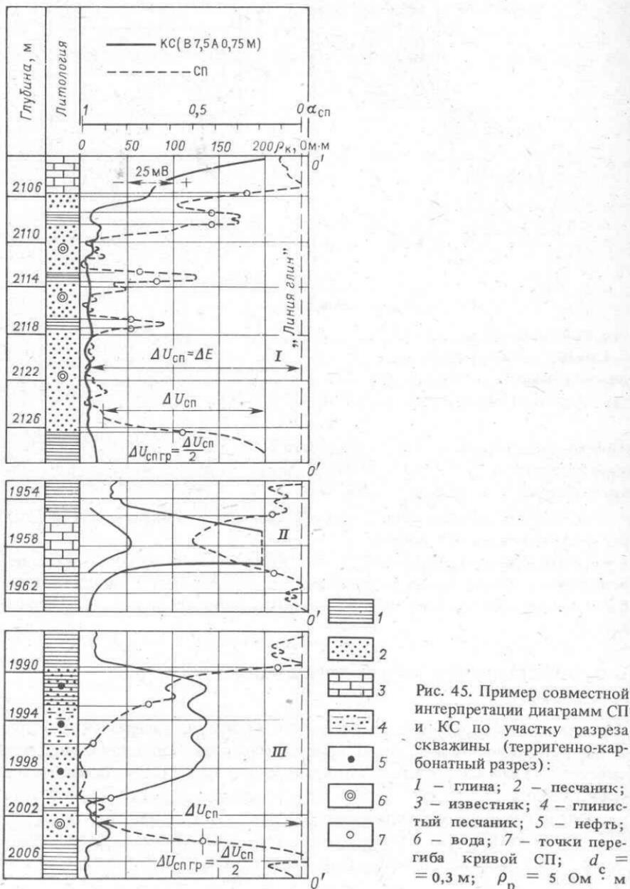
Рис. 45. Пример совместной интерпретации диаграмм СП и КС по участку разреза скважины (терригенно-карбонатный разрез):
